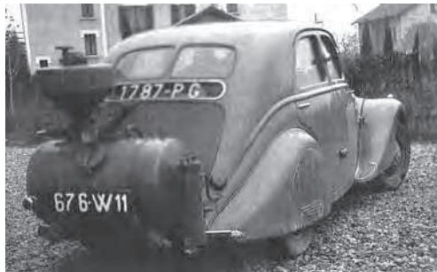
Véhicule ré-équipé d'un gazogène et circulant sous couvert d'une immatriculation W garage en attendant la refection de la carte grise. Immatriculation du département du Rhône 1938, plaque garage W 11 de l'arrondissement minéralogique de Lyon
