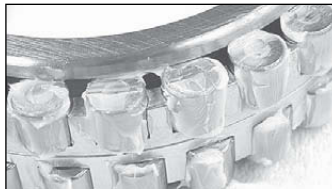
Fig. 2 : Graissage d'un Roulement à Rouleaux Cylindriques
